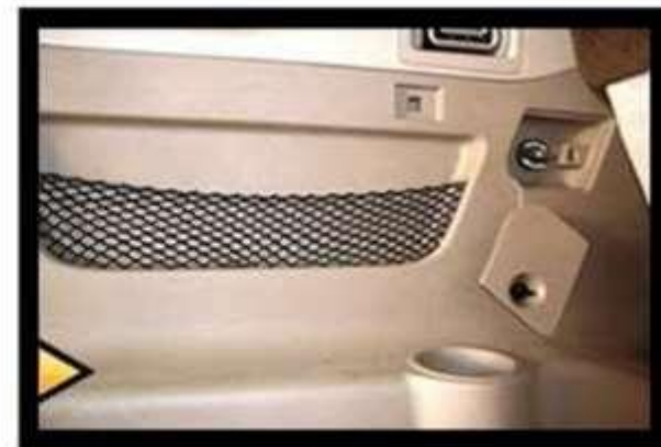
Ubicación del mando manual para la apertura eléctrica del portabán trasero
